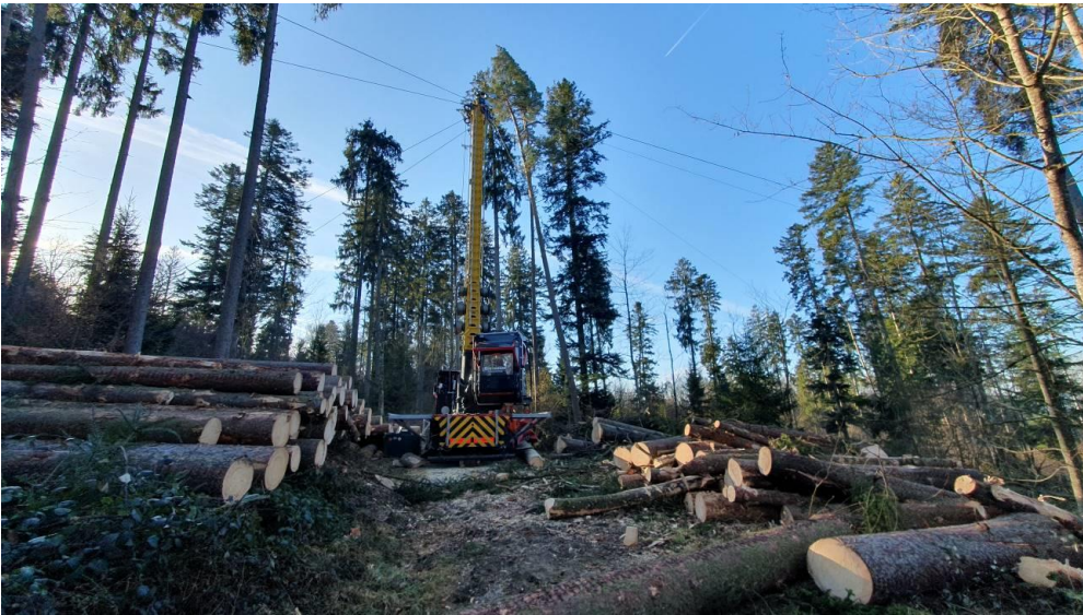
Einsatz einer Mobilseilkrananlage, wie man sie im Gebirge kennt, hier im Einsatz in Flachem Gelände in Berikon.
